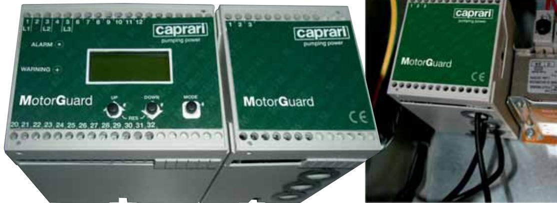
**MOTORGUARD** è un dispositivo elettronico per controllare e monitorare i gruppi elettropompa con motore elettrico asincrono trifase.
